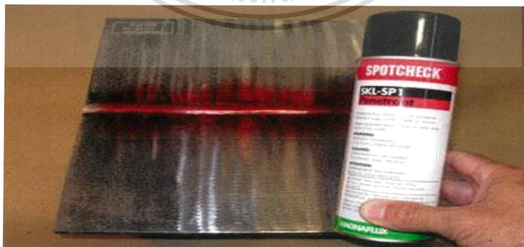
รูปที่ 3.57 พ่นสเปรย์ Penetrant ลงบนรอยเชื่อมที่ต้องการทดสอบบนขึ้นงาน
