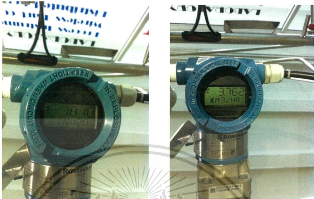
รูปที่ 4.3 อัตราการไหลที่อุปกรณ์วัดอัตราการไหล Annubar
