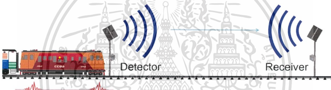
รูปที่ 3.1 แสดงภาพรวมการทำงานของระบบสัญญาณไฟเตือนโดยใช้การวัดการสั่นสะเทือน
