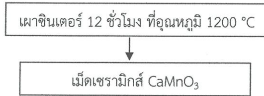
รูปที่ 3.7 แผนผังขั้นตอนการดำเนินงานการเตรียมสาร \text{CaMnO}_3
