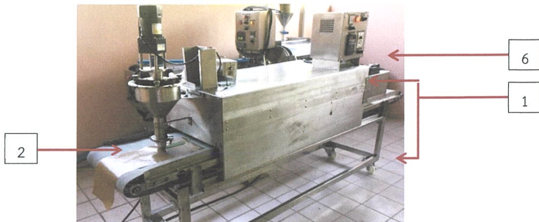
รูปที่ ค.7 อุโมงค์อบลมร้อนตัวที่ 1 (ด้านหน้า)
