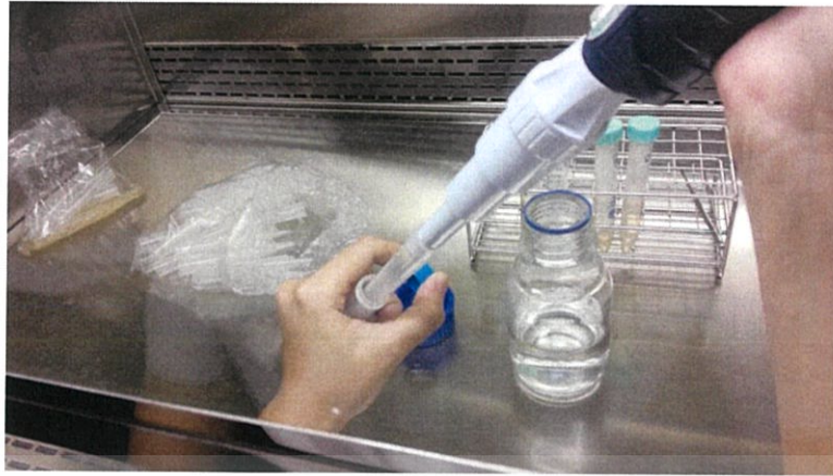
รูปภาพผนวกที่ ข-9 เทส่วนใสทิ้งเติมน้ำกลั่น 5 มิลลิลิตร ผสมให้เข้ากันแล้วนำไปปั่นเหวี่ยงอีกครั้ง
