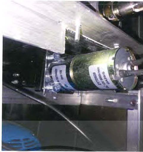
รูปที่ 3.30 มอเตอร์ไฟฟ้ากระแสตรงลำเลียง 2
