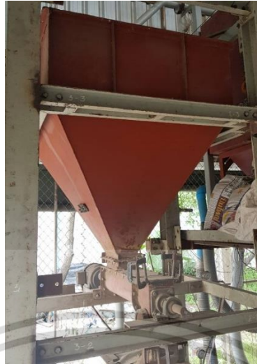
รูปที่ 4.3 ไซโลเก็บเชื้อเพลิงเม็ดและสกรูลำเลียงเชื้อเพลิง
