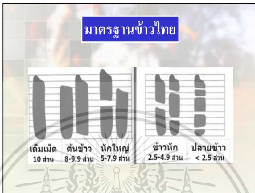
ภาพที่ 2.9 ลักษณะเมล็ดข้าวในมาตรฐานต่างๆตามลำดับ
