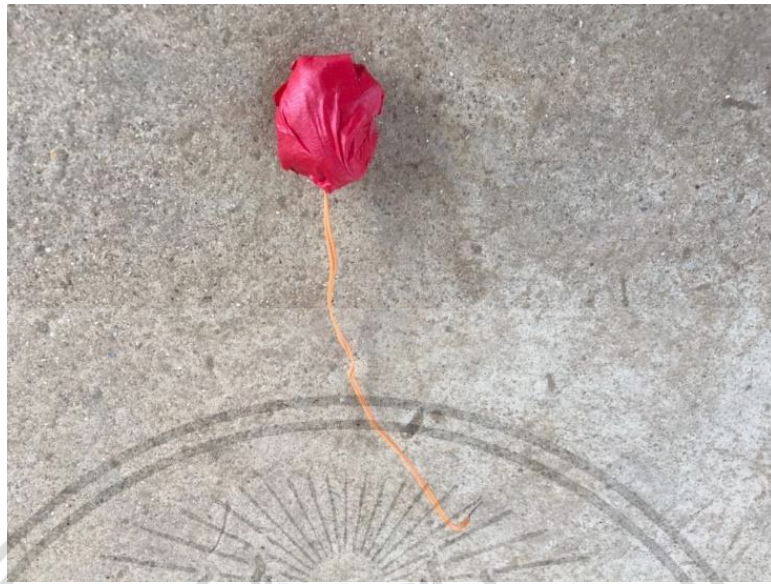
รูปที่ 3.2 ดินระเบิดที่พื้นเข้ากับฝักแครงระเบิด
