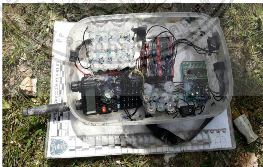
รูปที่ 2.6 ระเบิดแสงเครื่องแบบต่อวงจรเข้ากับวิทยุสื่อสาร
