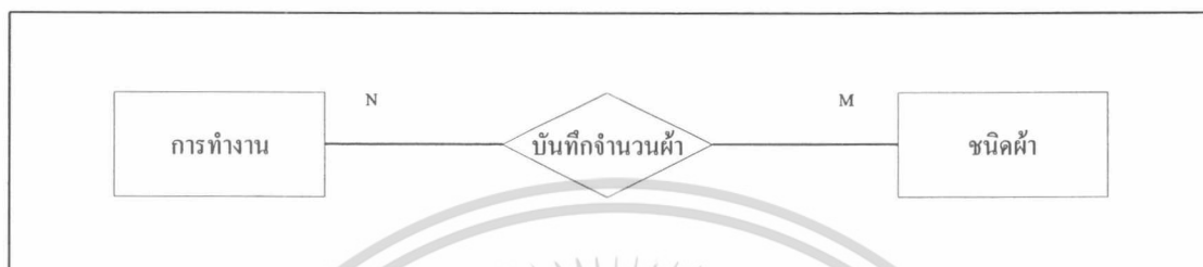
ภาพที่ 16 โมเดล E-R แสดงความสัมพันธ์ระหว่างเอนตี้การทำงานกับเอนตี้ชนิดผ้า
