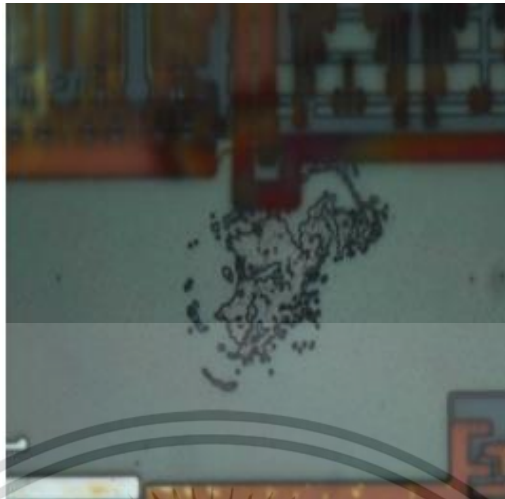
รูปที่ 4.7 ตัวอย่างข้อบกพร่องที่เกิดจากกระบวนการแพบริเคชัน
