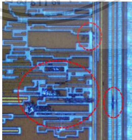
รูปที่ 4.12 ตัวอย่างความเสียหายที่เกิดจากแรงกระแทก
