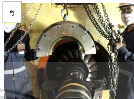
รูปที่ 3.6 ก) ถอด sleeve bearing ด้าน D-end และ ข) ด้าน ND-end
