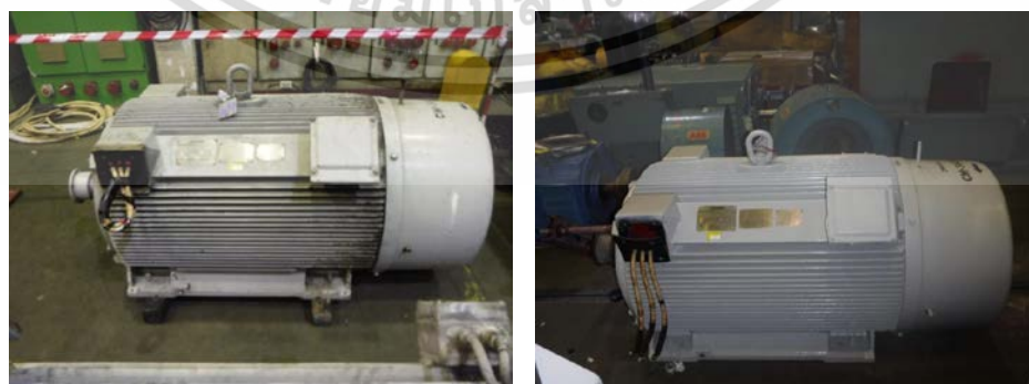
รูปที่ 3.17 มอเตอร์ขนาดพิกัดแรงดัน 6.6 kV ก) ก่อน Overhaul ข) หลัง Overhaul
