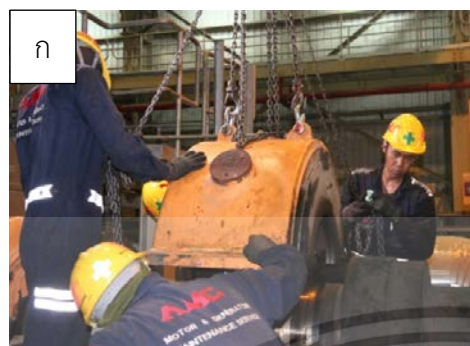
รูปที่ 3.6 ก) ถอด sleeve bearing ด้าน D-end และ ข) ด้าน ND-end
