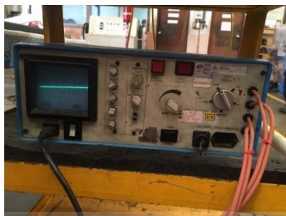
รูปที่ 4.14 เครื่องทดสอบเปรียบเทียบเสิร์จ
