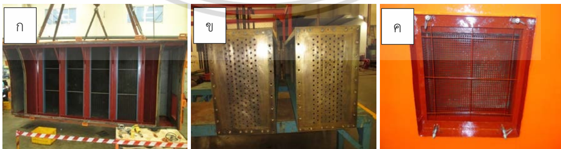
รูปที่ 3.14 ก) ส่วนของระบบระบายความร้อน ข) แยกส่วนประกอบระบบระบายความร้อน ค) หลังทาสี
