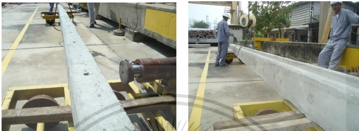
รูปที่ 3.23 แสดงการคลายกระบอกไฮดรอลิกออก และตรวจหารอยร้าว
