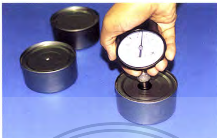
ภาพที่ 13 การวัดค่าความเป็นสุญญากาศของผลิตภัณฑ์ด้วย Vacuum gauge
