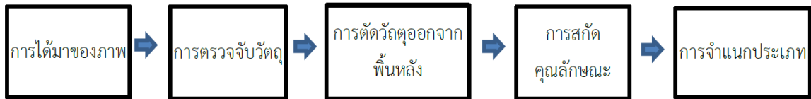
รูปที่ 2.14 แสดงขั้นตอนการวิเคราะห์ภาพของกระบวนการทางคอมพิวเตอร์วิทัศน์
