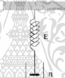
รูปที่ 2.39 แบบจำลองความยืดหยุ่นหนืดของ Maxwell [24]
