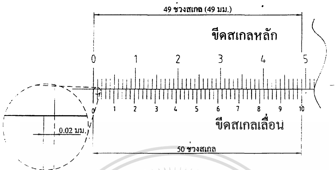
ภาพที่ 10 การแบ่งขีดสเกลค่าความละเอียด 0.02 มม.
