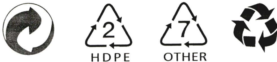
ภาพที่ 2.6 ภาพสัญลักษณ์จุดเขียว (Green dot) พลาสติกโพลีเอทิลีนความหนาแน่นสูง พลาสติกเคลือบหลายชั้น และกระดาษที่สามารถรีไซเคิลได้
