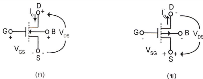
รูปที่ 2.4 แบบจำลองการทำงานของมอสเฟต (ก) NMOS (ข) PMOS
