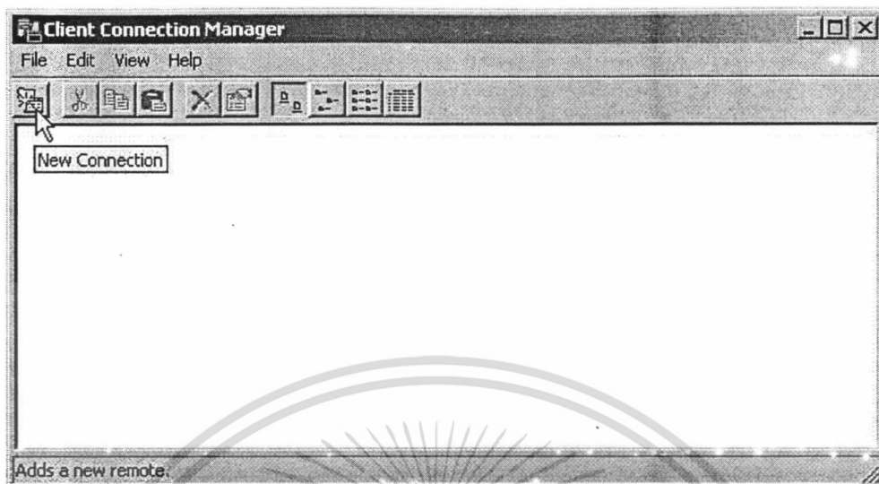
ภาพผนวกที่ 76 หน้าจอแสดงโปรแกรมเทอร์มินอลเซอร์วิสในการกำหนดการเชื่อมโยงโปรแกรมใหม่ โดยเลือกที่ New Connection
