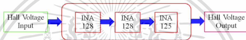
รูปที่ 3.12 การต่อวงจรถยายอินสตรูเมนต์จำนวน 3 ตัว
