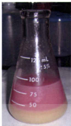
(ก) ผลการไทเทรตที่ทำการทดลองด้วยมือ
