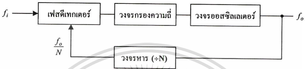
รูปที่ ข.1 บล็อกไดอะแกรมของวงจรสังเคราะห์ความถี่
