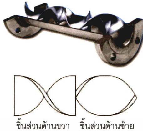
รูปที่ 2.6 ลักษณะของเครื่องผสมไร้การเคลื่อนที่และลักษณะของชั้นส่วนภายใน [20-21]
