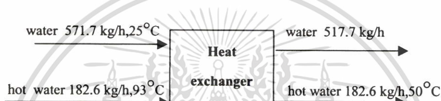
รูปที่ จ.2 แสดงสมดุลมวลของส่วนการแลกเปลี่ยนความร้อน
