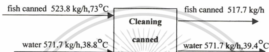
รูปที่ จ.3 แสดงสมดุลมวลของส่วนการล้างกระป๋อง
