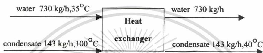
รูปที่ จ.4 แสดงสมมูลมวลของส่วนการแลกเปลี่ยนความร้อน
