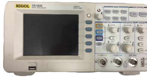
รูปที่ 3.11 ออสซิลโลสโคป รุ่น Rigol DS1052E
