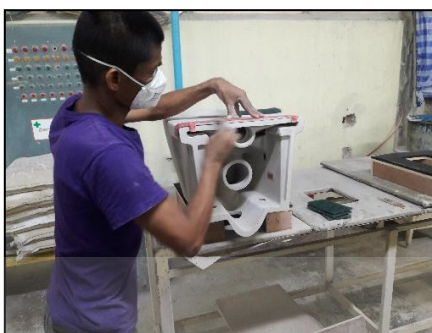
รูปที่ 5. 17 ภาพแสดงการชุดปรับฐานสุขภัณฑ์ด้วยใช้เกจชุด
