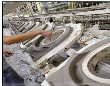
รูปที่ 2.13 แสดงวิธีการแกะแม่พิมพ์หลังจากเตรนน้ำดินออก และตัดเจาะส่วนขอบ
