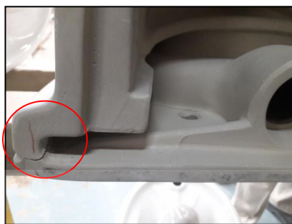
รูปที่ 5.15 แสดงการแตกร้าวตำแหน่ง 04 ที่แนวต่อริมด้านหลังของสุขภัณฑ์หลังเผา
