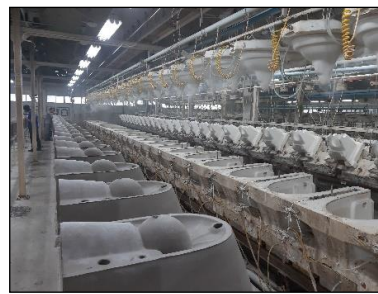
รูปที่ 2.15 ภาพแสดงวิธีการถอดชิ้นงานสุกภัณฑ์ออกจากแม่พิมพ์ปูนพลาสติกอร์
