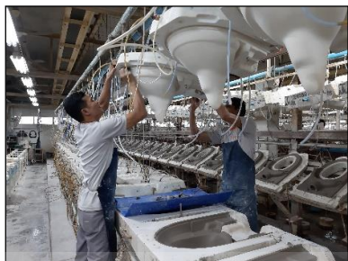
รูปที่ 2.13 แสดงวิธีการแกะแม่พิมพ์หลังจากเตรนน้ำดินออก และตัดเจาะส่วนขอบ
