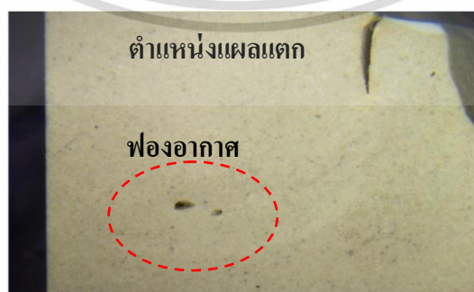
รูปที่ 4.14 ภาพขยายแนวตัดขวางตำแหน่งการแตกร้าวหลังเผา
