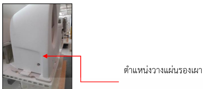
รูปที่ 5.9 แสดงการวางชิ้นงานสุขภัณฑ์รุ่น AC19 บนแผ่นรองเผาก่อนเข้าเตาเผา
