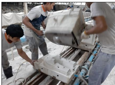
รูปที่ 2.15 ภาพแสดงวิธีการถอดชิ้นงานสุกภัณฑ์ออกจากแม่พิมพ์ปูนพลาสติกอร์
