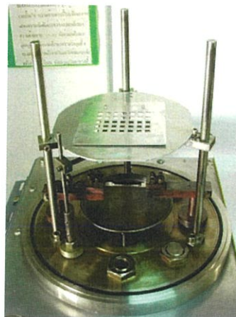
รูปที่ 3.2 แสดงอุปกรณ์ที่ใช้ในการเตรียม ไดโอดที่มีรอยต่อแบบวิวิธพันธุ์ของฟิล์มบางของสารกึ่งตัวนำ n-ZnSe/p-Si (100) โดยวิธีการระเหยสารเคมีด้วยความร้อน ภายในระบบสุญญากาศ
