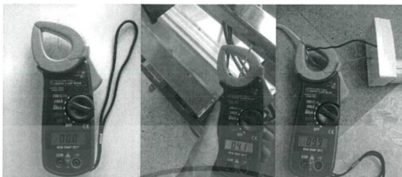
รูปที่ 3.12 เครื่อง DIGITAL CLAMP METER และวิธีการวัดกระแสไฟฟ้าในระหว่างอบแห้ง
