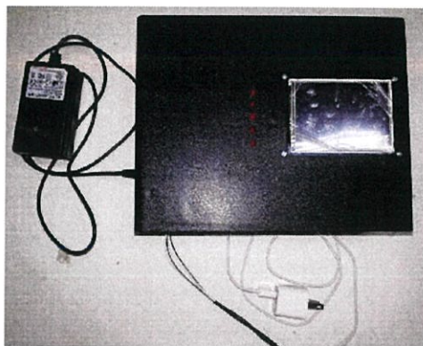
รูปที่ 3.16 กล่องอุปกรณ์ควบคุมการเปิด-ปิดเครื่องปรับอากาศ
