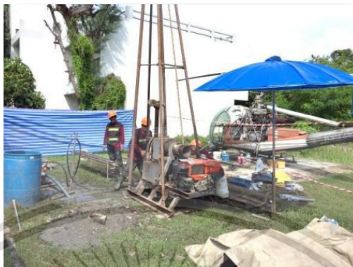
รูปที่ 5.20 แสดงสามขาในการเจาะสำรวจดินแบบ Wash Boring
