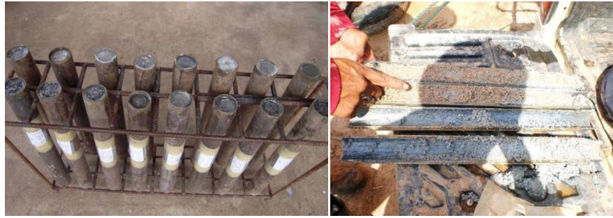
รูปที่ 4.25 แสดงกระบอกเก็บดินแบบผนังบาง (ซ้าย) และ กระบอกเก็บตัวอย่างดินแบบผ่า (ขวา) ที่มา : บริษัท ฟิเนสส์ ซอยล์ เทสติ้ง จำกัด
