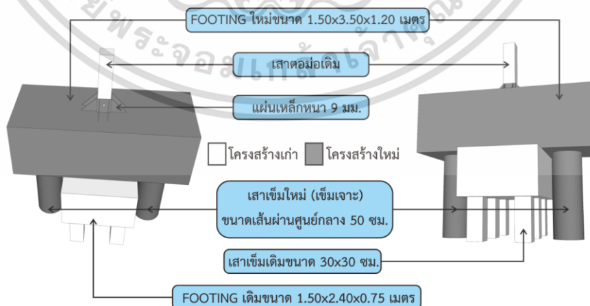
รูปที่ 5.57 แสดงการติดตั้งเสาะเข็มเจาะ (Bored Pile) แล้วเสร็จ
