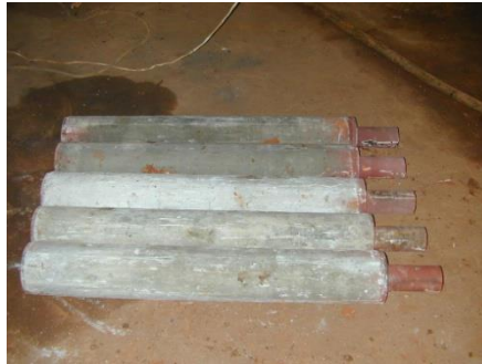
รูปที่ 4.49 แสดงเสาเข็มประกอบขนาด \varnothing 15 ซม. ยาว 1.50 เมตร เหล็กกลมกลางหุ้มด้วยคอนกรีต ที่มา : บริษัท พีเนสส์ ซอยล์ เทสติ้งจำกัด
