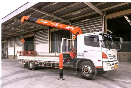
รูปที่ 5.81 แสดงรถยนต์บรรทุก 6 ล้อติดตั้งเครน ที่มา :บริษัท พีเนสส์ ซอยล์ เทสตั้ง จำกัด
