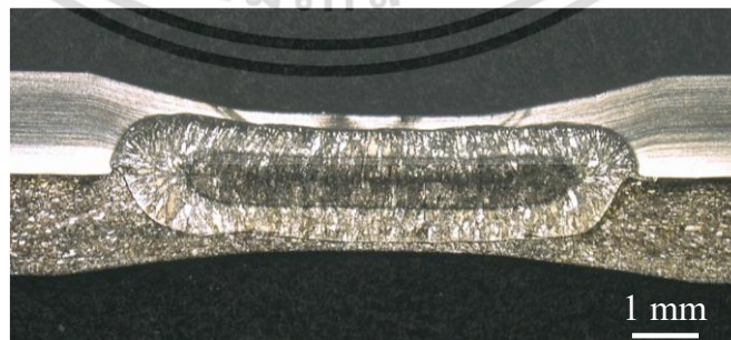
รูปที่ 4.28 ลักษณะโครงสร้างมหภาคของรอยเชื่อมที่ผ่านการเชื่อมด้วยกระแสเชื่อม 10.0 กิโลแอมแปร์ เวลาเชื่อม 38 ไซเคิล
