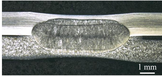
รูปที่ 4.21 ลักษณะโครงสร้างมหภาคของรอยเชื่อมที่ผ่านการเชื่อมด้วยกระแสเชื่อม 7.0 กิโลแอมแปร์ เวลาเชื่อม 25 ไซเคิล
