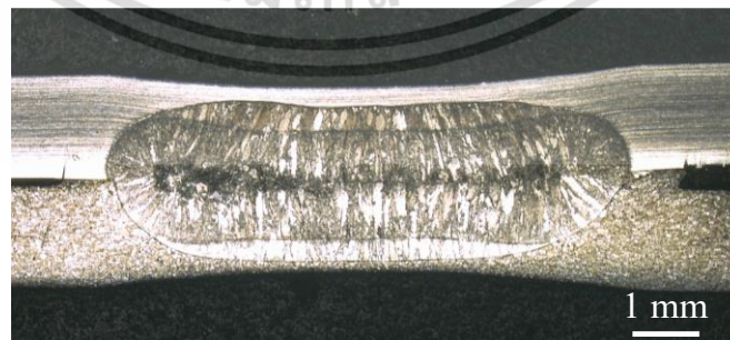
รูปที่ 4.24 ลักษณะโครงสร้างมหภาคของรอยเชื่อมที่ผ่านการเชื่อมด้วยกระแสเชื่อม 8.5 กิโลแอมแปร์ เวลาเชื่อม 25 ไซเคิล
