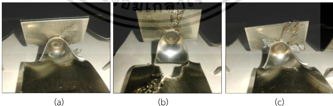
รูปที่ 4.42 ลักษณะการกระจายของน้ำโลหะเหลวที่เกิดจากการกระแสเชื่อม/เวลาเชื่อม (a) 8.5 กิโลแอมแปร์/50 ไซเคิล (b) 10.0 กิโลแอมแปร์/38 ไซเคิล (c) 10.0 กิโลแอมแปร์/50 ไซเคิล
