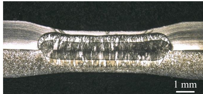
รูปที่ 4.29 ลักษณะโครงสร้างมหภาคของรอยเชื่อมที่ผ่านการเชื่อมด้วยกระแสเชื่อม 10.0 กิโลแอมแปร์ เวลาเชื่อม 50 ไซเคิล
