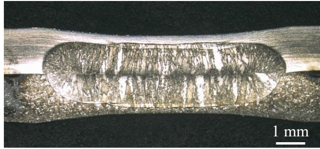
รูปที่ 4.25 ลักษณะโครงสร้างมหภาคของรอยเชื่อมที่ผ่านการเชื่อมด้วยกระแสเชื่อม 8.5 กิโลแอมแปร์ เวลาเชื่อม 38 ไซเคิล
