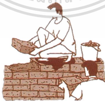
รูปที่ 2.7 แสดงการก่อผนังด้วยอิฐดินดิบ
