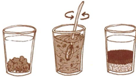
รูปที่ 2.5 การทดสอบเพื่อดูสัดส่วนของทราย ดินตะกอน และดินเหนียว
