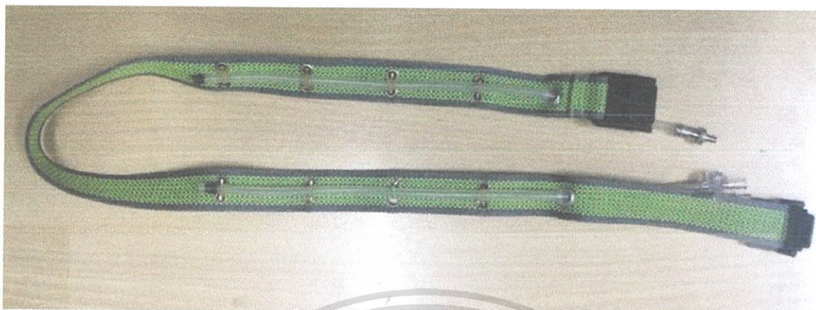
รูปที่ 3.2 ท่อซิลิโคนติดกับสายรัดหน้าอกใช้ในการตรวจจับการขยายของทรวงอก
