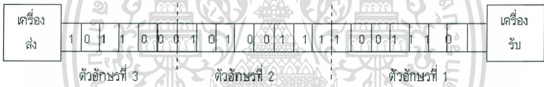
รูปที่ 2.28 การส่งผ่านข้อมูลแบบซิงโครนัส
