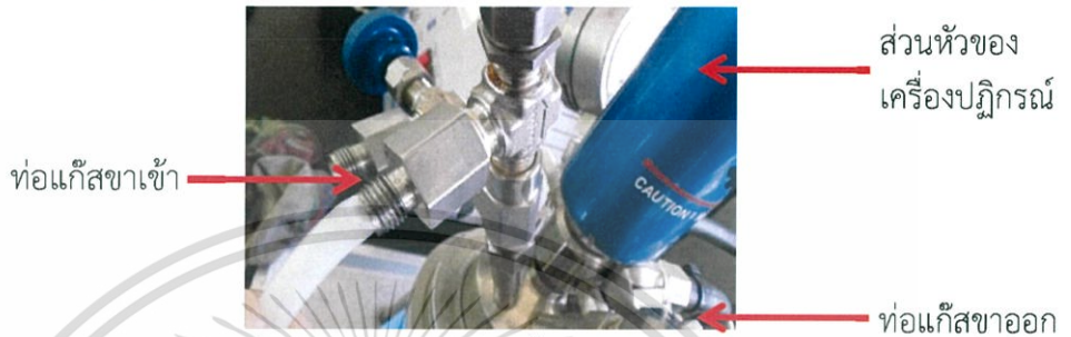
รูปที่ ข.1 ตำแหน่งการฉีดน้ำเข้าทางท่อแก๊สขาเข้า
