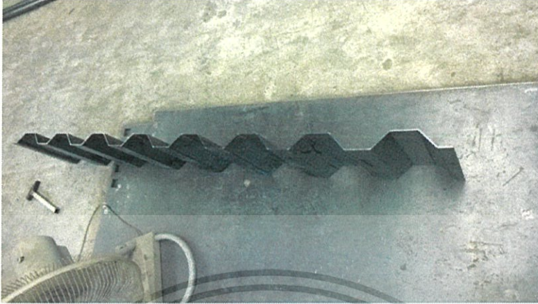
รูปที่ 3.3 พับแผ่นเหล็กให้ได้ขนาด
