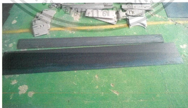
รูปที่ 3.2 ตัดแผ่นเหล็กให้ได้ขนาดและความยาวตามที่ออกแบบ
