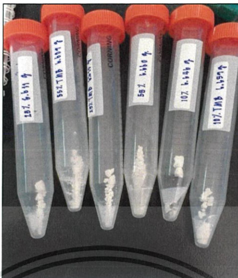
รูปที่ 3.2 อนุภาคนาโนซิลิกาที่มีรูพรุนชนิดเมโซที่ได้หลังจากการอบแห้ง
