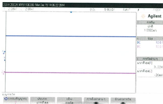
รูปที่ 4.7 เมื่อป้อนอินพุตเป็น 3.3 โวลต์
