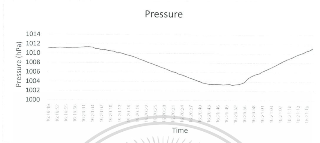
รูปที่ 4.8 กราฟแสดงผลของความกดอากาศที่ได้รับจากดาวเทียม CANSAT เทียบกับเวลา
