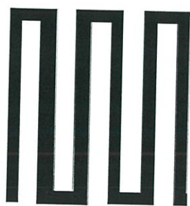
รูปที่ 2.2 ลักษณะสายอากาศมีแอนเตอร์ไลน์ [2]
