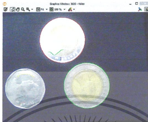
รูปที่ 4..25 ภาพที่ผ่านคำสั่ง edges sub pix, select shape xld, sort contours xld
