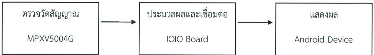
รูปที่ 3.2 บล็อกไดอะแกรมการทำงาน
