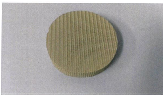
รูปที่ 3.4 อุปกรณ์กรองมลพิษอนุภาคแบบไหลผ่านบางส่วน
