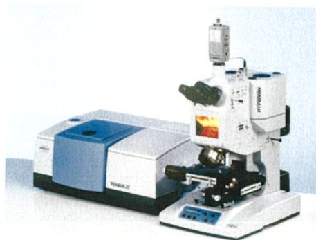
รูปที่ 3.7 FTIR-Test ตรวจสอบสภาพของน้ำมันหล่อลื่น และตรวจหาสิ่งปนเปื้อน
