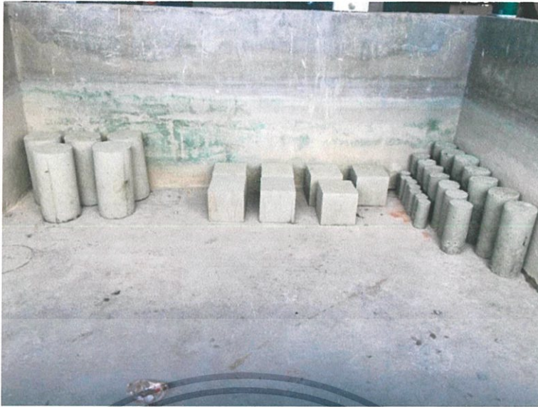
รูปที่ 3.6 แท่งคอนกรีตที่หล่อในท่อ PVC (ทั้งหมด 21 ตัวอย่าง) และ แท่งคอนกรีตที่หล่อในแบบหล่อมาตรฐาน (ทั้งหมด 14 ตัวอย่าง)
