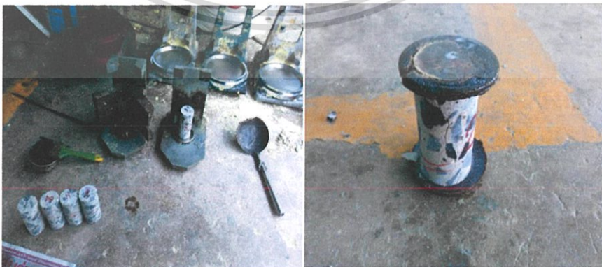
รูปที่ 3.17 ลักษณะการเคลือบหัวและท้ำยของแท่งคอนกรีตที่หล่อในแบบท่อ PVC และแท่งคอนกรีตที่
