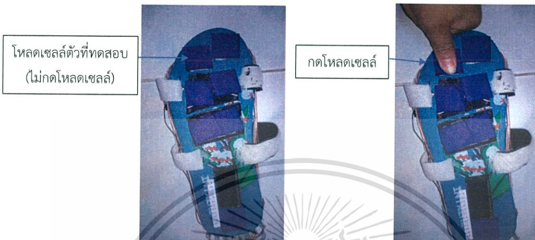
รูปที่ 4.2 การทดสอบโดยการกดและไม่กดโพลิตเซลล์
