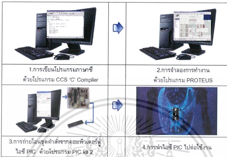
รูปที่ 2.10 ลำดับขั้นตอนการใช้งาน PIC [8]
