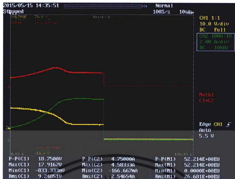
รูปที่ 5.63 กราฟแสดงคุณลักษณะของเซลล์ไฟฟ้าแสงอาทิตย์ที่ความเข้มแสง 520 วัตต์/ตารางเมตร
