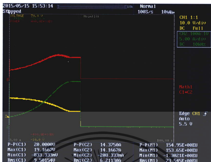
รูปที่ 5.90 กราฟคุณลักษณะของเซลล์ไฟฟ้าแสงอาทิตย์ที่ความเข้มแสง 650 วัตต์/ตารางเมตร
