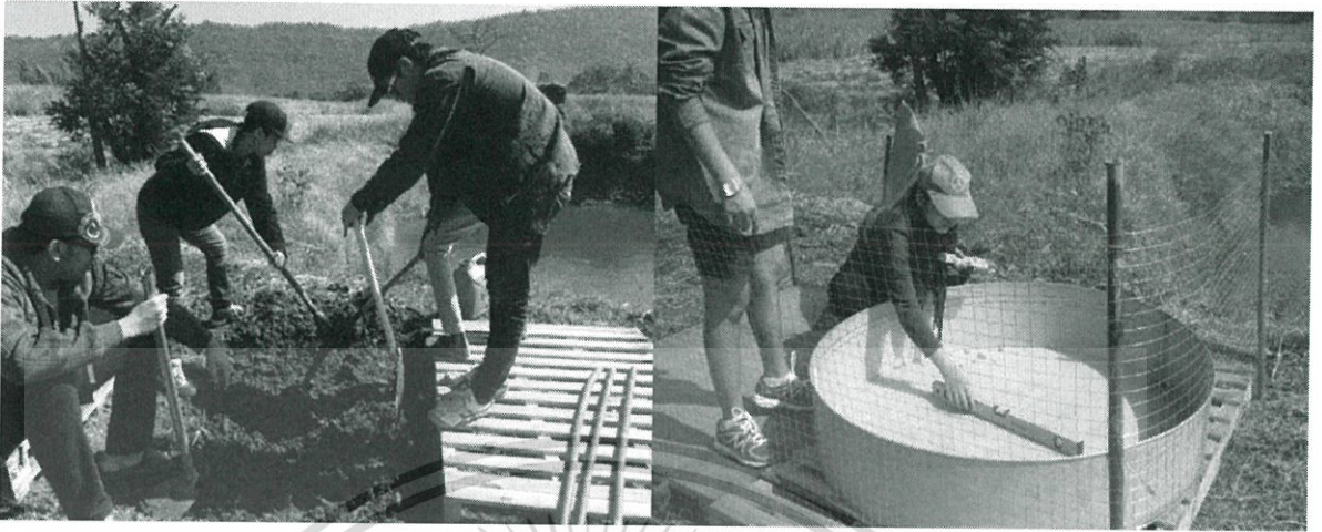
รูปที่ 3 ขั้นตอนการเตรียมพื้นที่ เพื่อติดตั้งถาดวัดการระเหย Class A
